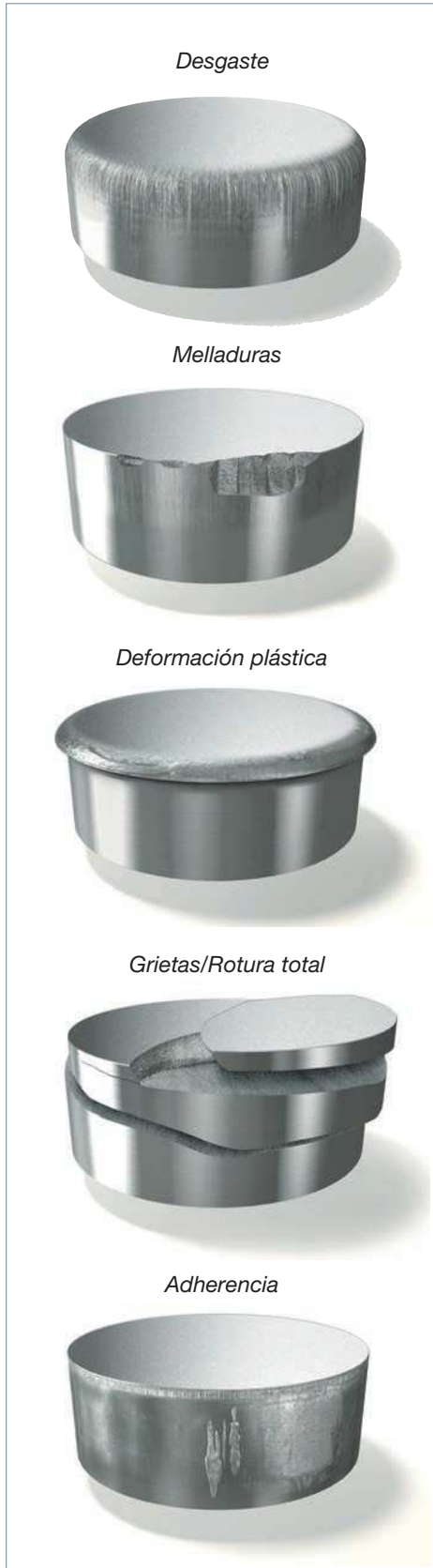
Fig. 3. Mecanismos de fallo más frecuentes en aplicaciones de trabajo en frío.
