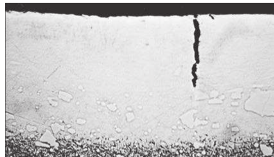
Foto 4. Superficie de Uddeholm Sverker 21 después de haber realizado un electroerosionado de desbaste. La capa blanca es frágil y contiene grietas.
