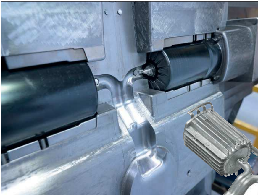
Bomba de aluminio fijado al sistema de llenado, por ejemplo cámaras, puntos de inyección y rebosadero.
