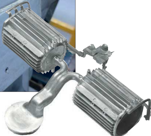
Bomba de aluminio fijado al sistema de llenado, por ejemplo cámaras, puntos de inyección y rebosadero.
